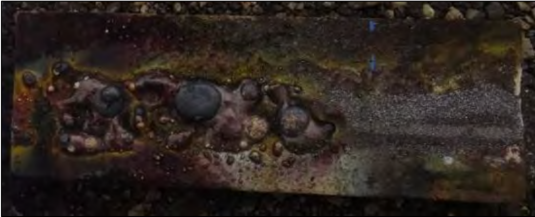
Photo 3: UN Test N.1 - Trial 1 (partial consumption, <180mm)
