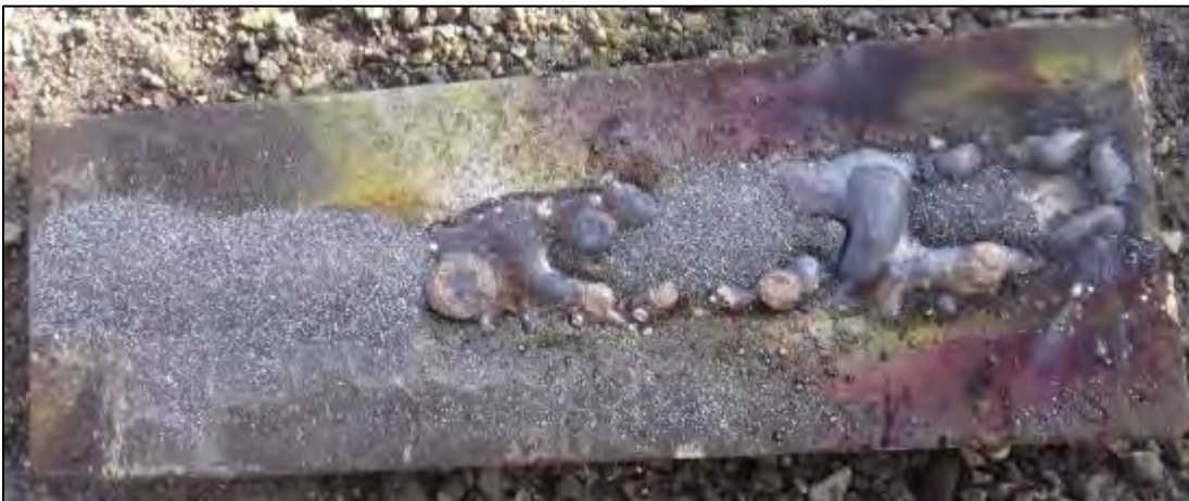
Photo 5: UN Test N.1 - Trial 5 (partial consumption, <180mm)
